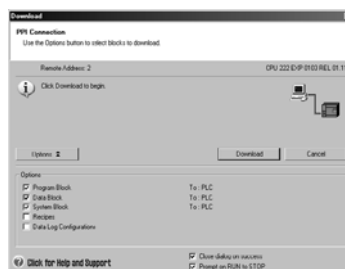
Rysunek 2-11 Ładowanie programu do sterownika
