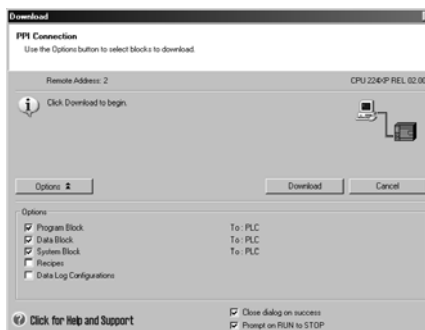
Rysunek 4-13 Ładowanie projektu do sterownika
