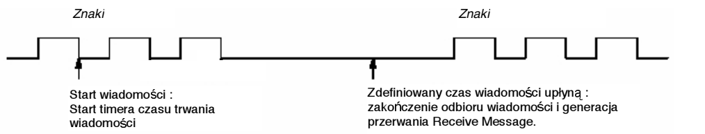
Rys. 6-13 Zastosowanie timera do odmierzania czasu do zakończenia instrukcji odbioru.
