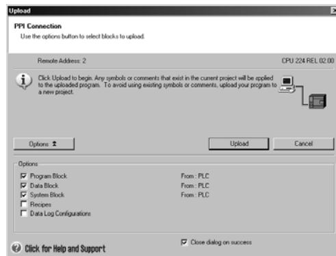
Rysunek 4-14 Odczytywanie projektu ze sterownika
