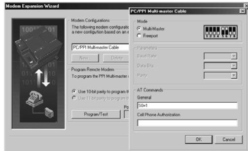
Rysunek 7-27 Konfigurator zdalnego modemu – komenda inicjalizacji wysyłania danych
