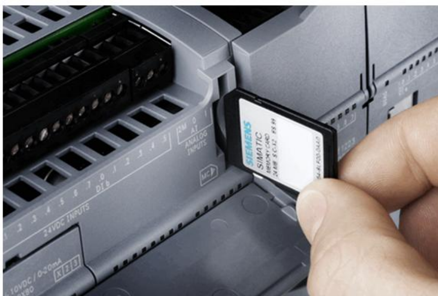
Rys.2. Sposób umieszczenia karty pamięci w sterowniku
