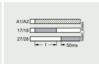
YΔ 3RP2005-B Star-delta (wye-delta) function
