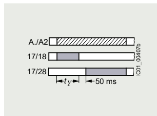
3RP257-.NM20, 2 NO, star-delta (wye-delta) function
